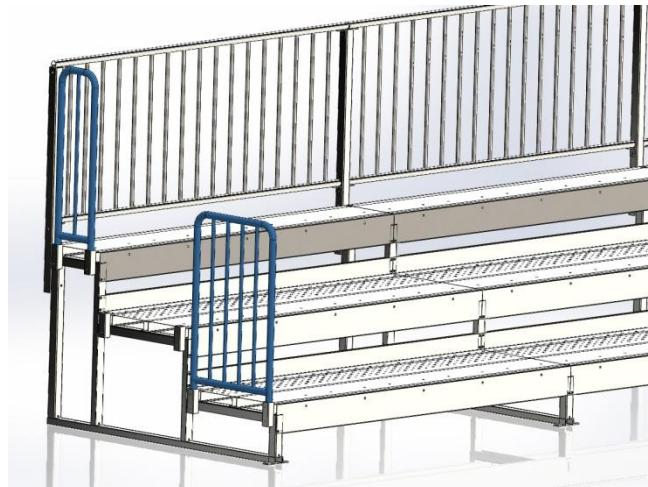
Verschrauben Sie das Teil Nr. 9 mit den Sechskantschrauben M10x140 und den Muttern M10. Setzen Sie die mitgelieferten oberen und unteren Kunststoffendkappen 60x60 ein.
