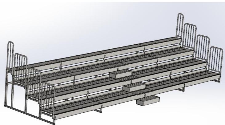
Verschrauben Sie das Teil Nr. 13 mit den Sechskantschrauben M10x140 und den Muttern M10. Setzen Sie die mitgelieferten oberen und unteren Kunststoffendkappen 60x60 ein.
