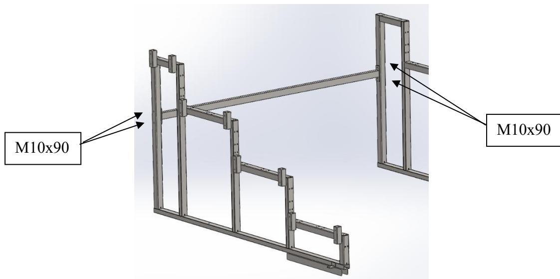
2. Verschrauben Sie die Teile Nr. 5-6 mit den Teilen Nr. 1-2-3 mit den Inbusschrauben DIN 7380 M8x25 und M8 Unterlegscheiben.
