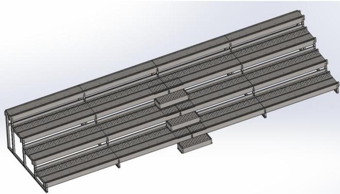
Befestigen Sie die erste Stufe mit den 6x60 mm Schrauben am Fundament.
