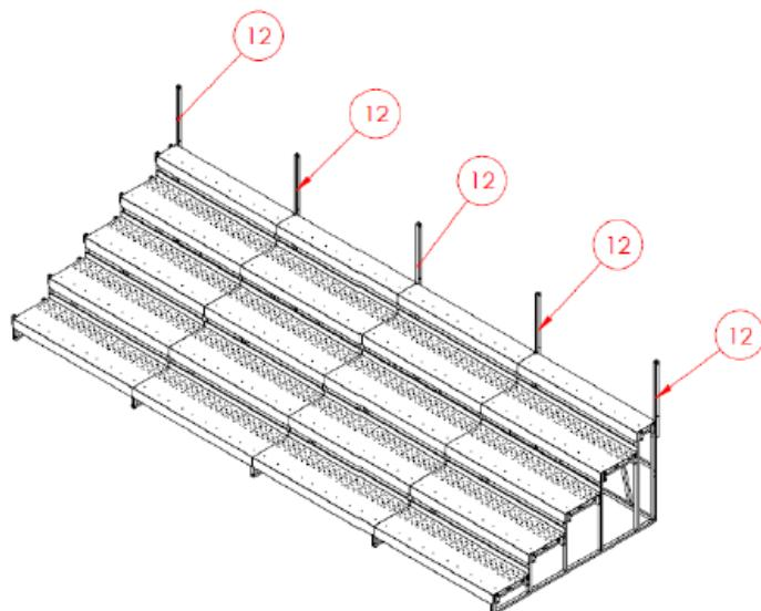
Setzen Sie die seitlichen Geländer in die vorgesehenen Aufnahmen ein und befestigen Sie die Geländer mit den mitgelieferten Inbusschrauben DIN 7380 M8x10
