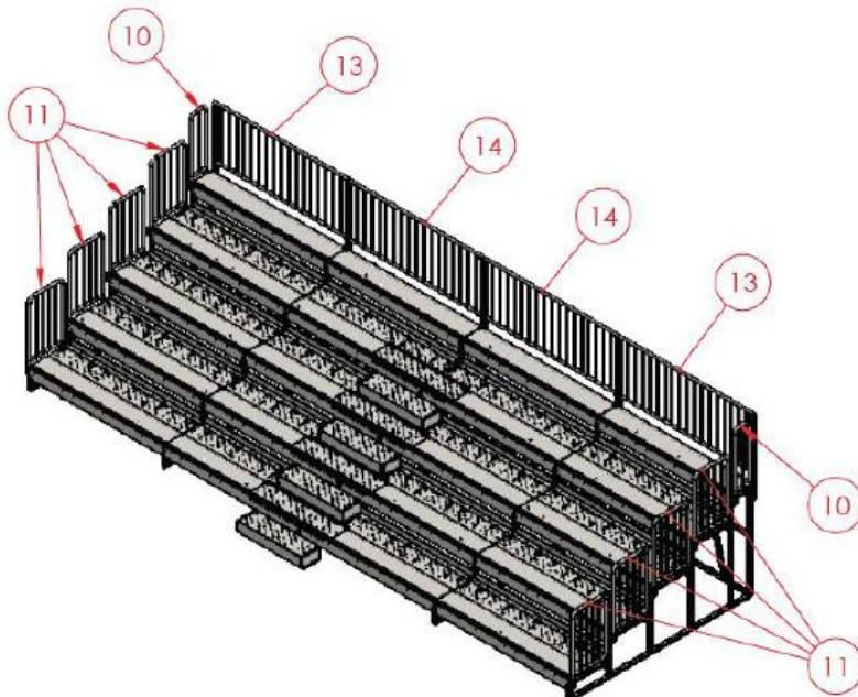
Setzen Sie die 40 mm Kunststoffendkappen auf beiden Seiten der hinteren Geländer (oben und unten) ein, Nr. 13-14.
