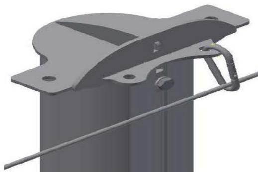
**8.** Das Ende des Stahlseils mit dem Karabinerhaken in den zuletzt erreichbaren Pfostendeckel einhaken. Zum Schluss das Stahlseil festhalten und durch drehen der Spanngarnitur (**28**) das Stahlseil spannen.
