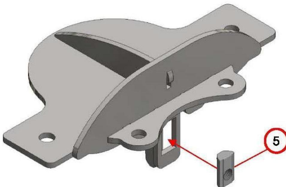
**3.** Schieben Sie den fertigen Pfostendeckel und den darin liegenden Nutenstein M8 (5) in die Nut des Pfostens. Schrauben Sie die Sechskantschraube M8x12 (6) mit der Unterlegscheibe M8 (7) in den Nutenstein M8 (5). Ziehen Sie die Schraube so fest an, dass der Deckel nicht mehr vom Pfosten abnehmbar ist.
